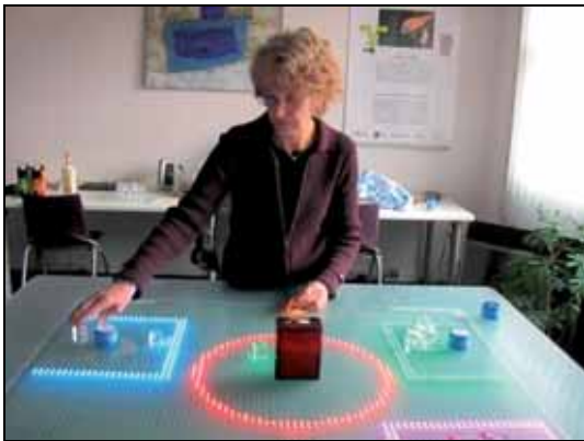
Figure 2 Un sujet (Brigitte Meillon, LIG) trie sur Tangisense un ensemble de sonorités dans des paniers. Les sons associés aux cubes sont dévoilables devant le haut-parleur. Les paniers sont positionnables à partir de leur centre matérialisé par une boîte bleue.
