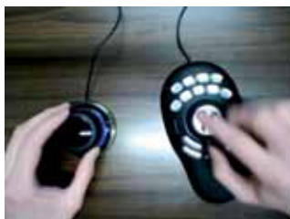
Figure 3 : Interaction bimanuelle et assignation: navigation à la main gauche (souris 3D) et manipulation à la main droite (contrôleur rotatif).
